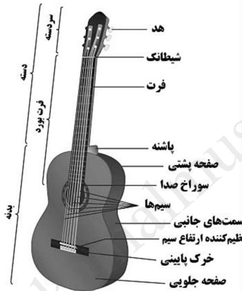
شکل ۲-۲. اجزای مختلف گیتار کلاسیک.
